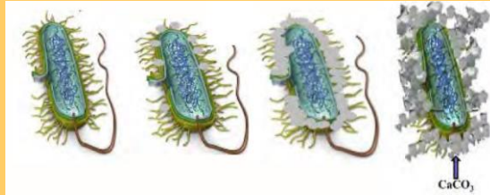
مراحل رسوب کلسیم کربنات بر روی پوسته باکتری از طریق هیدرولیز اوره
